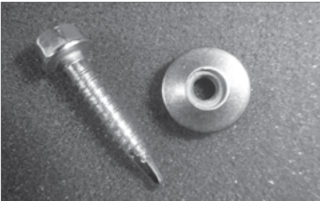
Tornillo autoperforante de acero inoxidable de 5,5 x 30 mm con arandela de goma para fijar el colector al riel de montaje.
