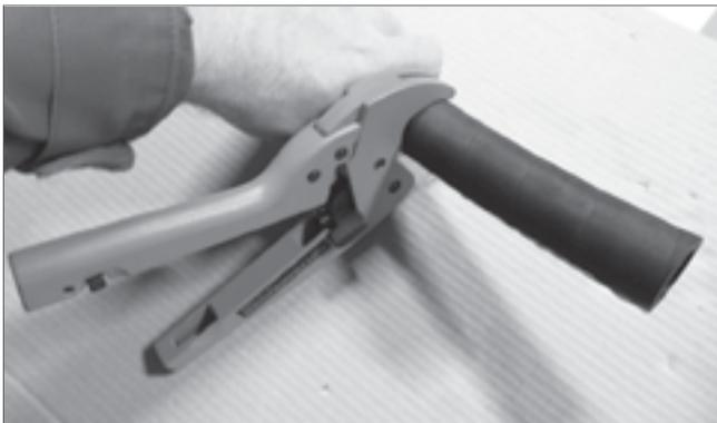
Corte la manguera de conexión de 40 mm al menos a 12 cm con el cortatubos.
